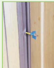
당사 안전도어 설치 후 문짝을 수차례 밀어 손 끼임사고를 재연해 보았습니다.
